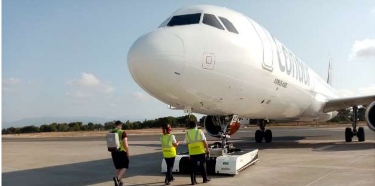
Imagen de un operario de Acciona, remolcando de forma teledirigida un avión, junto a dos instructores
